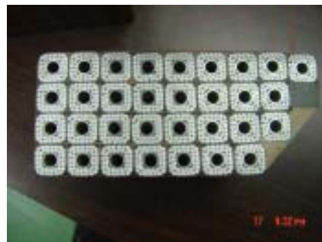
図4：ストランド線を使用した4極電磁石コイル。
