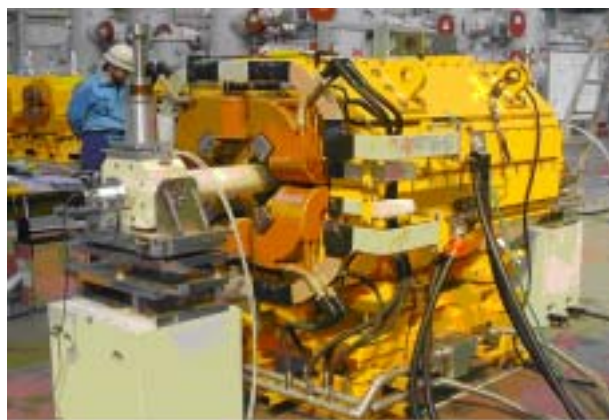
図 7 : MR 用 4 極電磁石磁場測定風景
