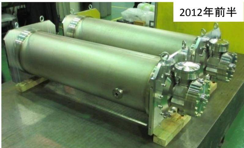
空洞単体での性能確認後、Ar封入した2台の空洞にHeジャケットを溶接。高圧ガス検査を行った後にKEKに。
