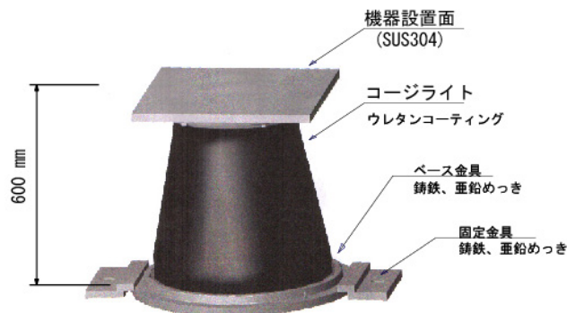
図4 低熱膨張セラミック（コーザライト）を使用した安定架台。
