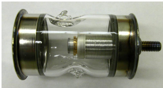
図 3: カートリッジ式カソードの試作品 ベローズ先端に直径 7.2 mm のカソードがあり、リング状の RF コンタクトが付いている。
