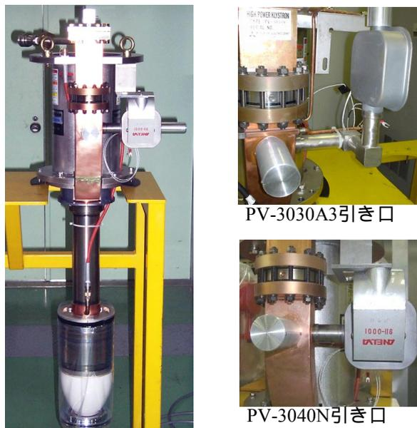
図1：PV-3040Nクライストロン外観写真。PV-3030A3をベースに改良している。真空引き口の径を大きく、長さを短くして真空排気能力を向上させ、PV-3030A1（約1.2l/s）に比べ実効排気量はおよそ3.3l/sに増加している（気温20 の場合に換算）。
