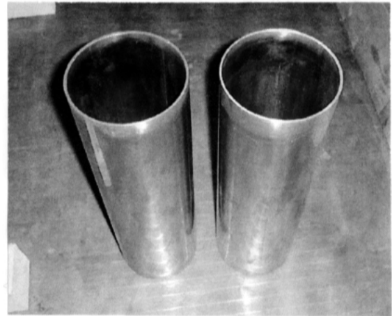
図4 引抜き製管したクラッド管
