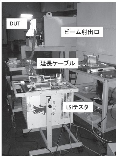
図8 中性子照射実験の様子
