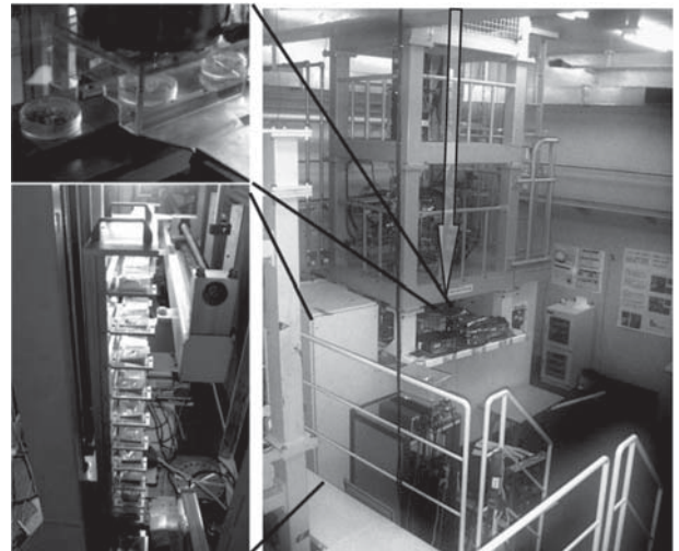
図3 深度制御種子照射装置。大気中に取り出したビームをパレット上の試料に照射する(左上)ため、鉛直ビームライン(矢印)の末端に設置され、試料パレットを収容できるストッカー(左下)が装着されている。
