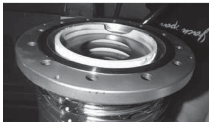
図12 リークを発生したECRイオン源入射部の前段加速管。振動でセラミクスが破壊された。
