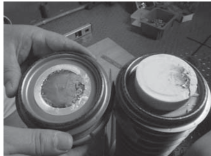
図11 完全に破断したカラムポスト。1本で最大3.4tonを支える。
