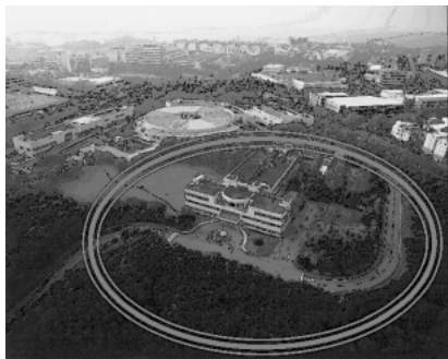
図12 NSRRC 将来計画. 背景に見えるのが現 NSRRC であり, 敷地いっぱいを使って 500 m 以上の周長を持つ放射光加速器を作ろうという計画である.
