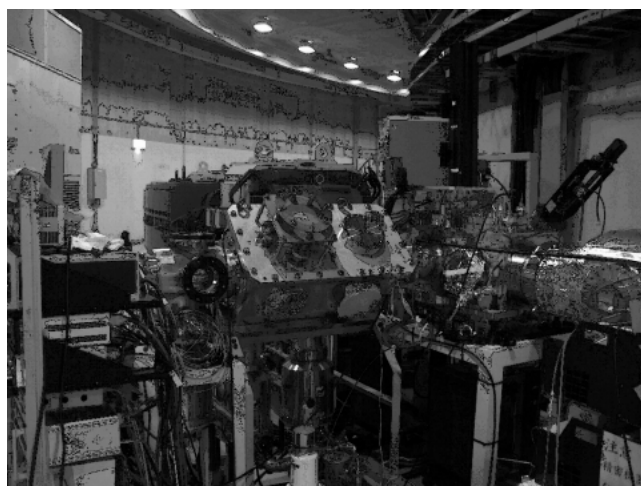
図2 装置写真。左手に見える円筒形が gas-jet chamber であり、次が slit-, magnet-chamber (矩形) である。このとき、収束磁石は slit chamber に収められている。Monitor chamber は HIMAC シンクロトロンリングの一部であり、シンクロトロンビームは、写真の後方より右手に見えるダクトを通過して走る。Monitor chamber 上に垂直に立つ黒いポストスタンドには、カメラと光学系がセットされる。
